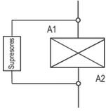
A1 y A2 son los bornes de la bobina del contactor.
